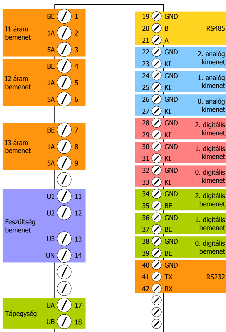
2.4. ábra: TMTG-3X Sorkapocs kiosztás
